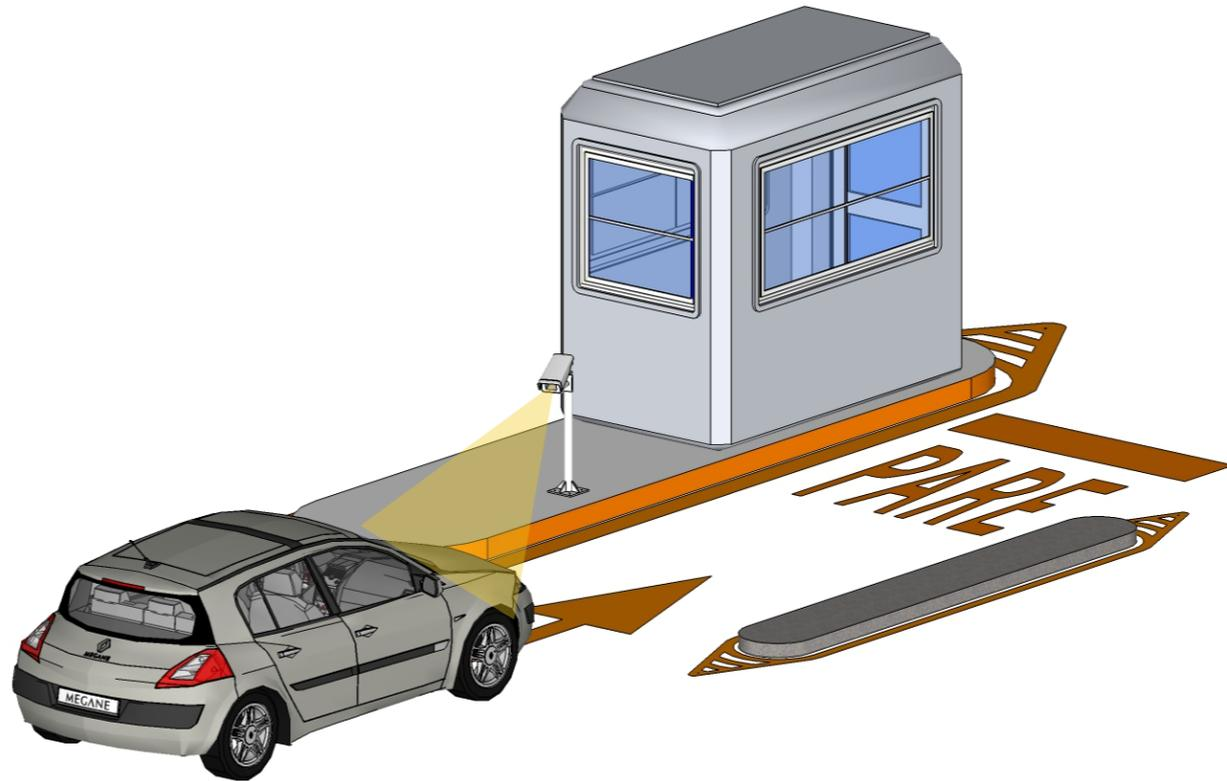
A câmera PlateCap detecta a aproximação e identifica a placa do veículo, enviando a mesma para o software da Engeltec.
