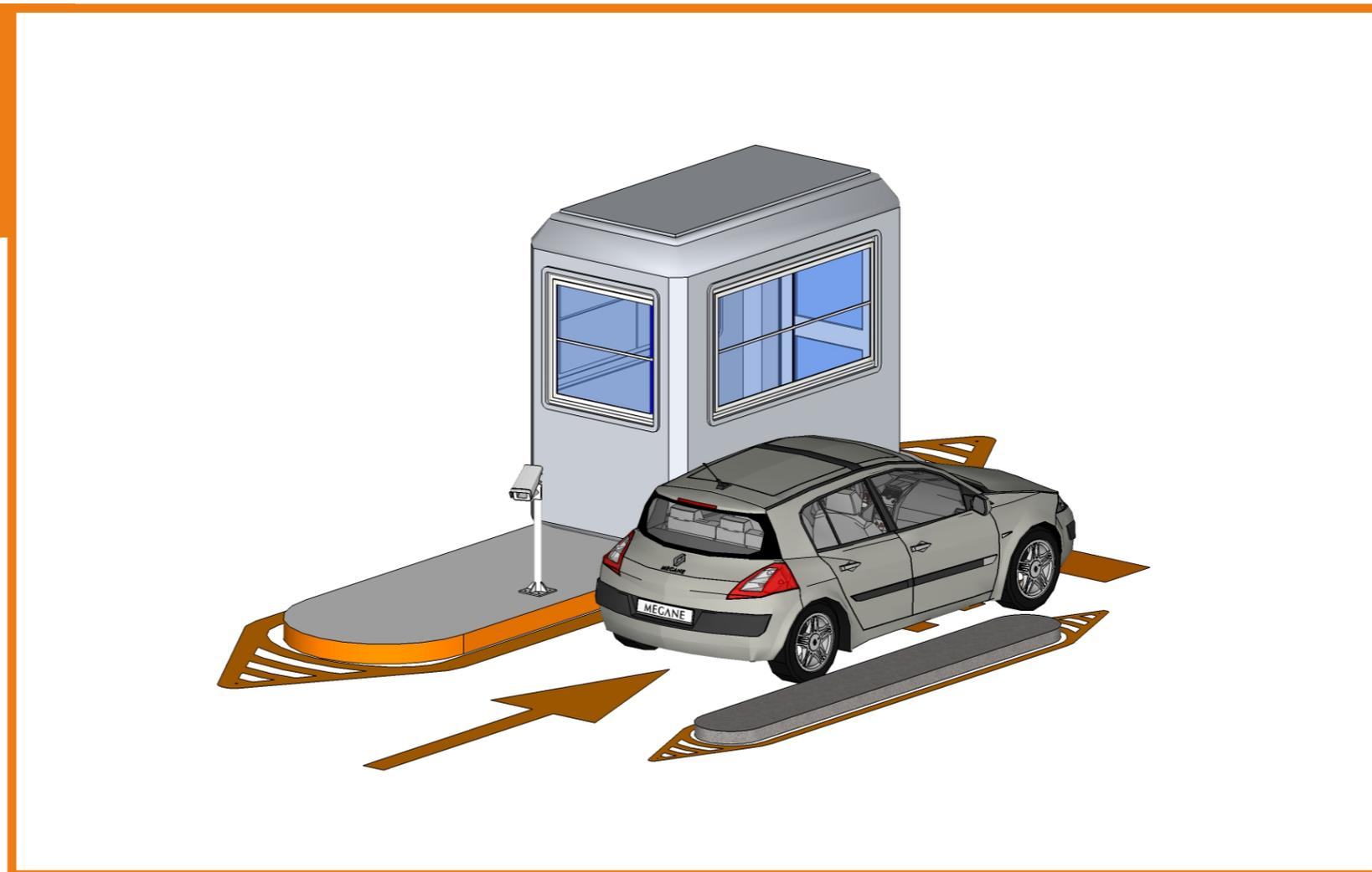
O Software do KitCounter recebe a placa, abre um acesso criando um ticket com a placa do veículo e automaticamente envia este ticket para a impressora. O operador entrega o ticket manualmente ao cliente.
